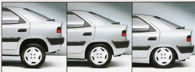
Xantian jousituksessa on neljä valinnaista korkeutta – ylin on tarkoitettu hetkelliseen ajoon hyvin huonokuntoisilla teillä, välisosuus sopii vaikeakuisille siirtymäosuuksille. Normaaliasento takaa parhaan mahdollisen ajomukavuuden ja alin korkeus on tarkoitettu tavaratilan lastaamiseen.
