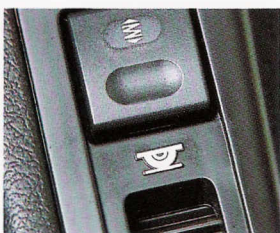
Hydractive II -kaasunestojousituksen käyttövipu
