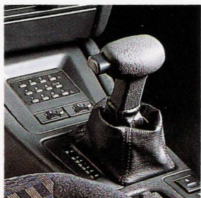
Henkilökohtaisella koodilla varustettu käynnistyksenestojärjestelmä
