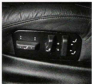
Kuljettajan istuin voidaan varustaa sähköisillä säätimillä.
