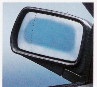
Sävytetyt ulkopeilit ovat lämmitettävät.
