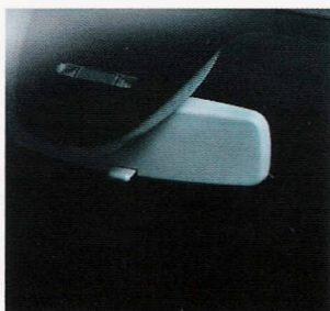
Automaattiset tuulilasinyyhkimet ohjautuvat sateen määrän mukaan.
