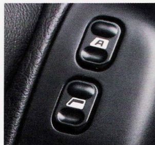
Etusivuikkunoita säädetään sähköisesti.
