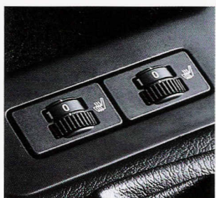
Istuinlämmittimen säätö on 3-vaiheinen.
