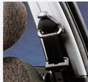
Eturuvävöiden yläkiinnikkeessä on yksilöllinen korkeussäätö.
