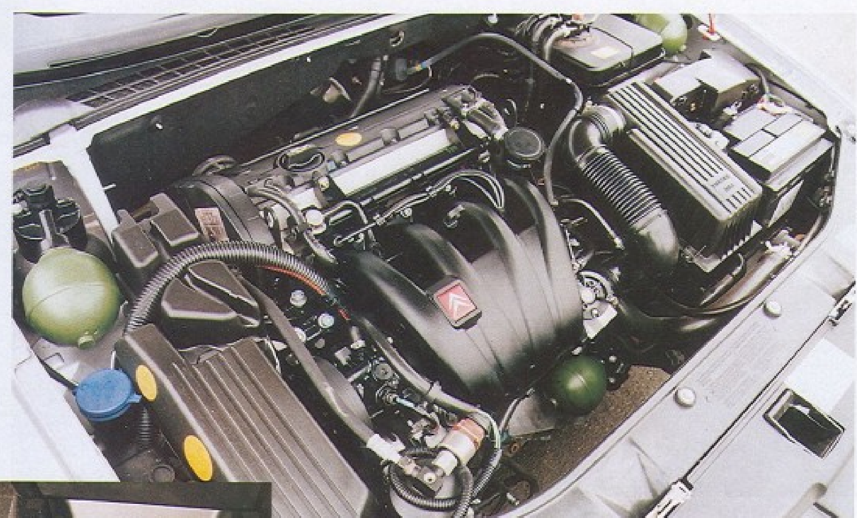
換上了PSA集團代號XU10J4R的2.0升DOHC 16汽門引擎，該引擎先前已出現在同集團的寶獅406之上，而與其搭配的Auto-Active四速自排變速箱(見左圖)為法國三大車廠與德國西門子公司所共同研發的新產品，在寶獅406上要等到'99年式車型才改用這套系統(現行406上的是ZF產品)。
