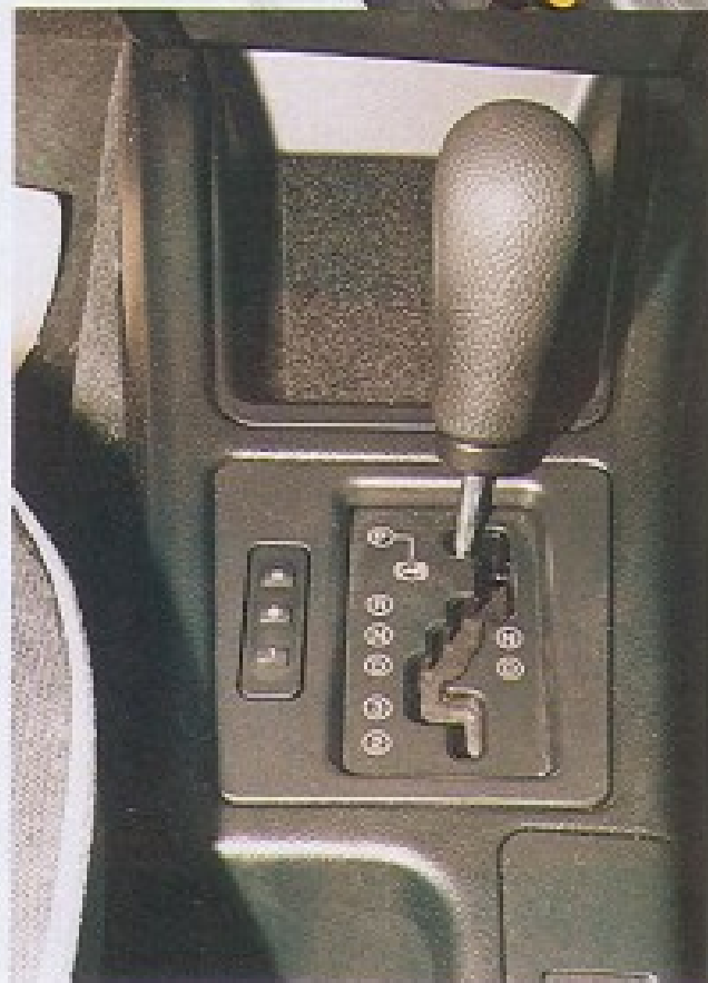
換上了PSA集團代號XU10J4R的2.0升DOHC 16汽門引擎，該引擎先前已出現在同集團的寶獅406之上，而與其搭配的Auto-Active四速自排變速箱(見左圖)為法國三大車廠與德國西門子公司所共同研發的新產品，在寶獅406上要等到'99年式車型才改用這套系統(現行406上的是ZF產品)。
