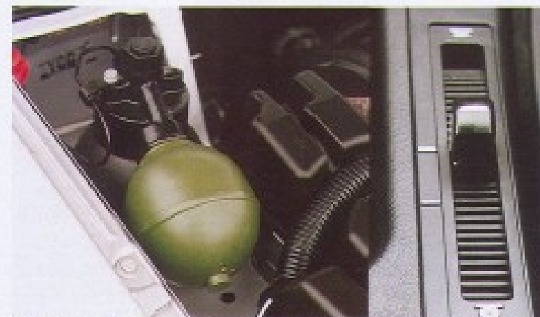
左圖為雷鐵龍液壓懸載系統的液壓球，內置高壓氣球和液壓油用以取代圈狀彈簧，並可作四段車身高度調整。右圖即為調整車高的拉柄。
