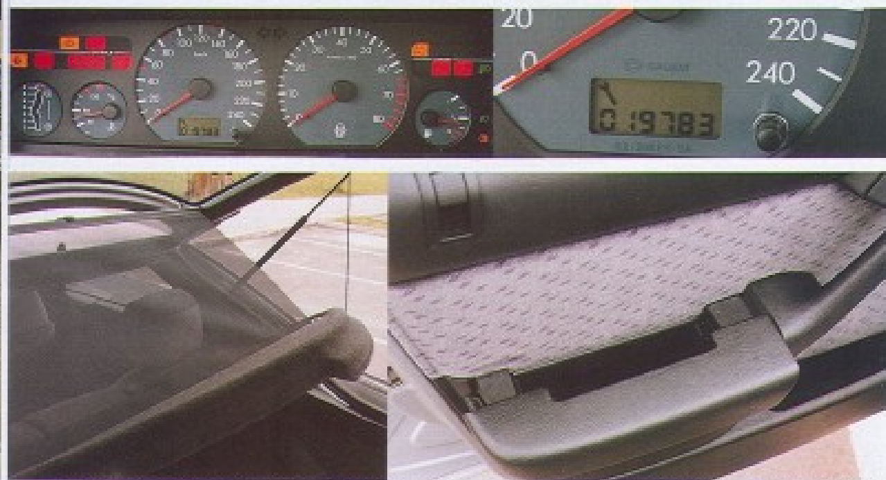
由左上圖開始，按順時針方向依序為：左方增加了顯示自由預位顯示的儀表板；位於時速表下方的定期保養里程顯示器；前門扶手滑動式置物箱；後窗手動遮陽簾。
