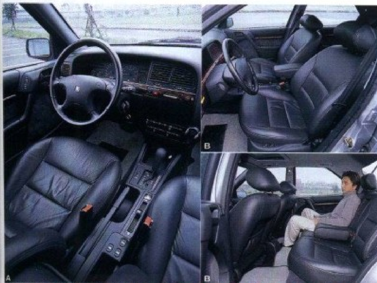
A. 排檔桿後方的撥桿就是控制車身高度的控制桿，有四種車身高度控制模式。雖然看似平凡，不過Xantia的原裝皮椅觸感非常良好。
