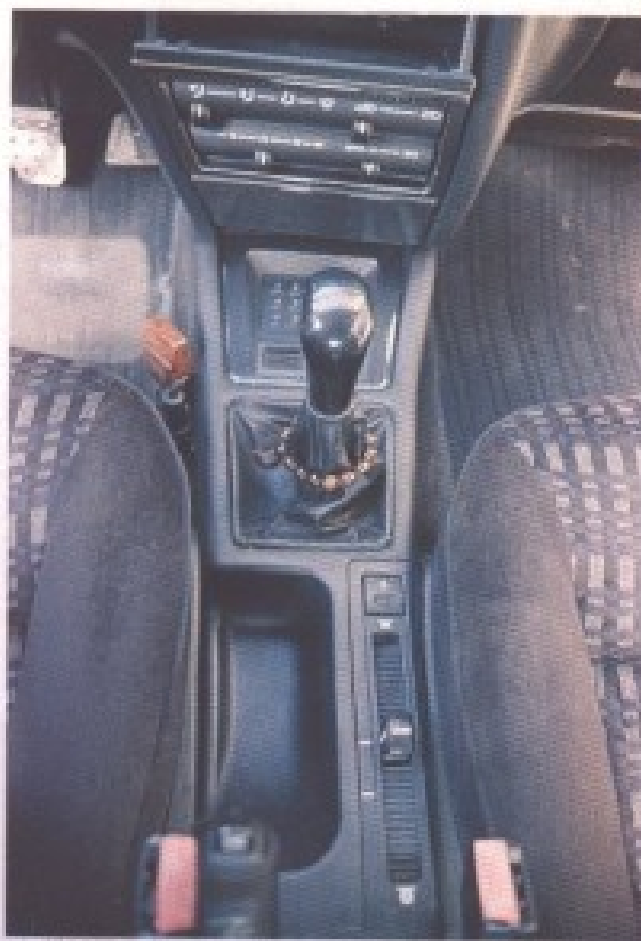
▲排檔頭換成SPARCO CARBON，而下方的兩桿則是CITROEN 獨家科技「液壓懸吊」的高級調整桿。
