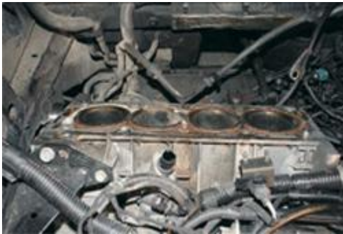
Näkymät kannen alla olivat kauniit. Vaikka mittarissa on yli 240 000 kilometriä, sylintereissä ei ole lainkaan kulumaa. Hoonausjäljet näkyvät vielä sylintereissä!
