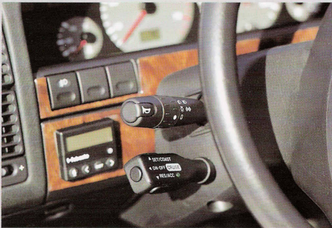
Vakionopeussäädin, ROSTRA 16V Webasto lämmitysjärjestelmä
